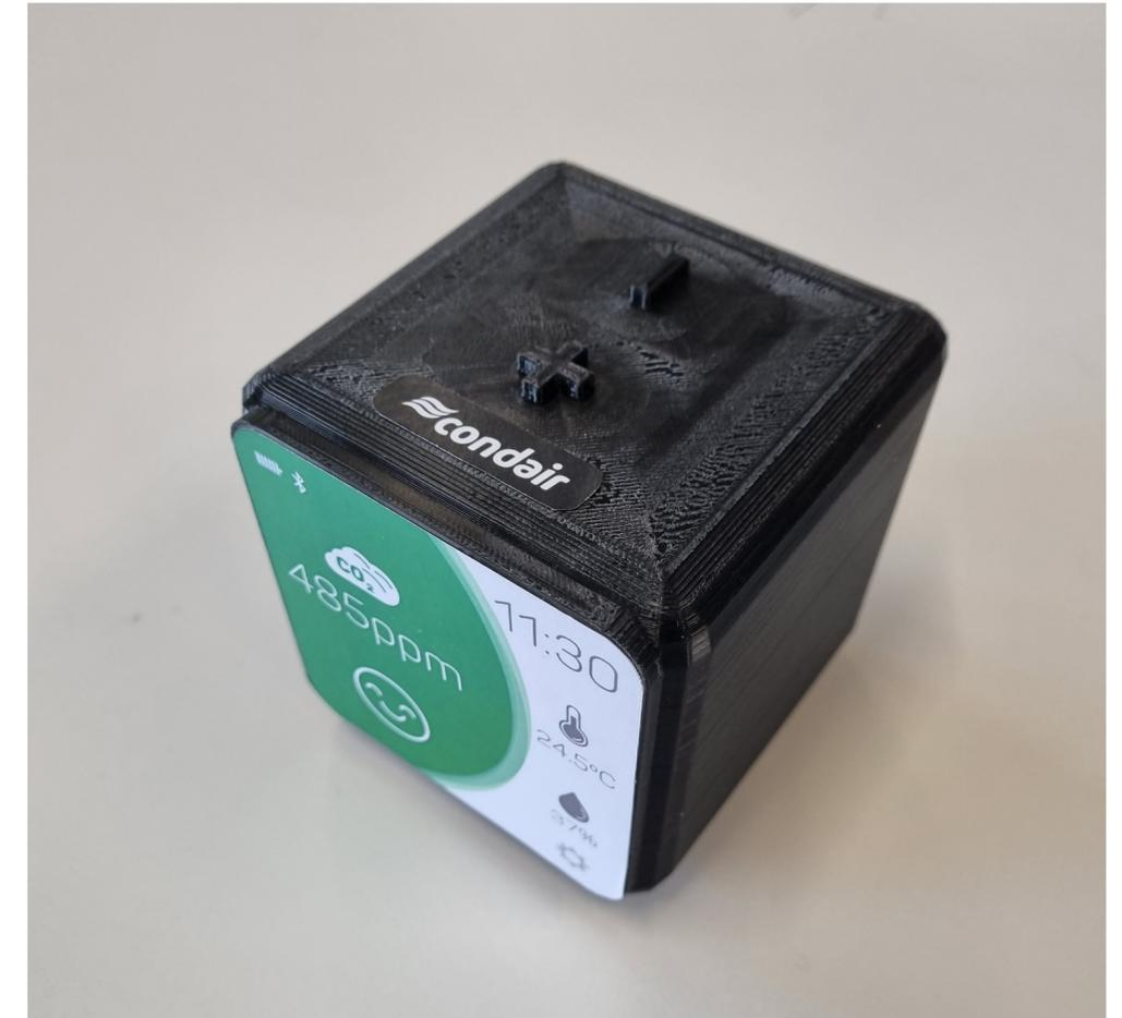
Unser 3D-gedruckter Prototyp ermöglichte es den Testern, sich ein realistisches Bild davon zu machen, wie sich der endgültige Cube in der Hand anfühlen würde.
